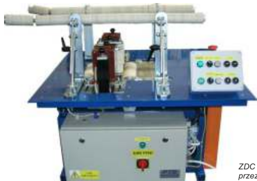
DZL-700 służy do obniżenia szczątkowego magnetyzmu dużych łożysk.
